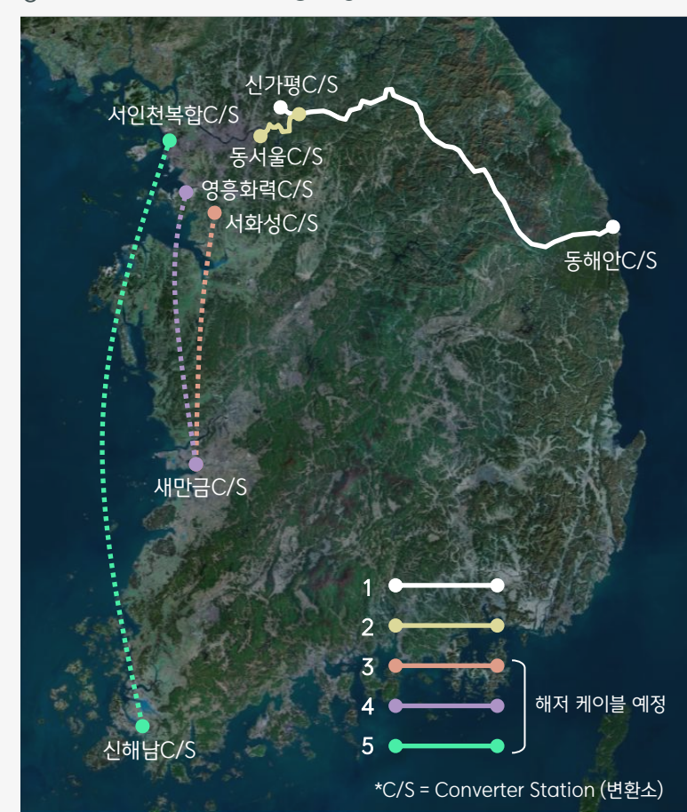
Figure 19: 수도권 HVDC 송전망 계획 노선도 및 사업개요
